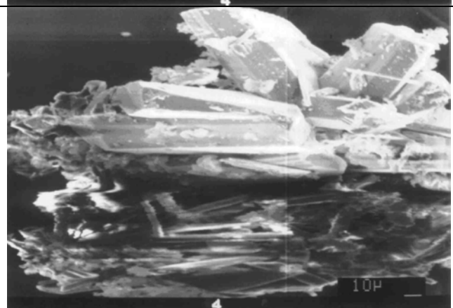
Mineralsalzkrystalle entstanden nach weiterer Verdampfung des unbehandelten Wassers (Parallelprobe) ebenfalls vom Vol. 1.200 ml auf 250 ml.
